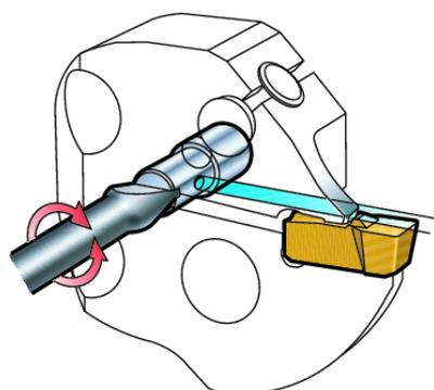
Las lamas de corte CoroCut SL y Q-Cut SL disponen de una ubicación integrada para el tubo de refrigerante en el centro del acoplamiento. Los tubos tienen un agujero lateral para dirigir el refrigerante hacia el filo. Si se sustituye el tubo de refrigerante, utilice un destornillador para ajustar el ángulo del agujero.
