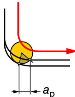
$f_{n1}$  = cortes paralelos – grosor máx. de viruta 0,15–0,40 mm
