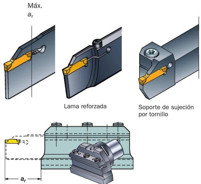
Para conseguir superficies de corte perpendiculares y reducir la tendencia a la vibración, el portaherramientas se debe montar:
