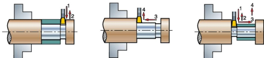
1. Penetrar radialmente hasta alcanzar la profundidad requerida + 0,2 mm (máx. 0,75 x anchura de la plaquita).
