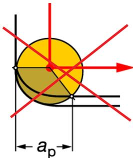
Radio de la plaquita  $<$  radio de la pieza
