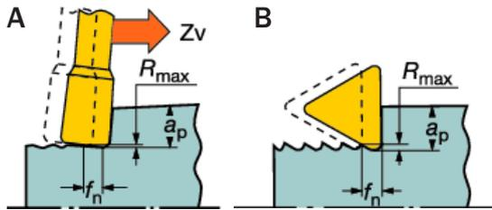
Comparación entre CoroCut (A) y las herramientas para torneado convencionales (B). En el gráfico se refleja la comparación del acabado superficial conseguido.
