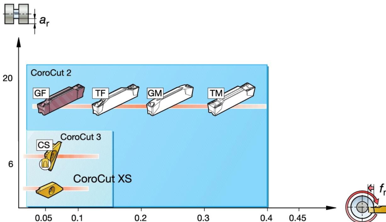
La primera elección para distintas operaciones de ranurado es la solución CoroCut de 2 filos. Utilice la geometría GF para avance reducido y la geometría GM para avance más alto.
